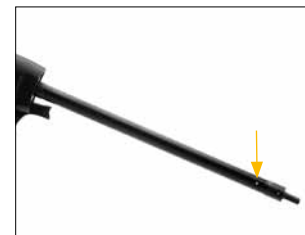
Mettere alcune gocce di olio nell'apertura del tubo della carcassa.
