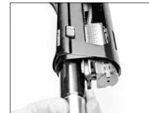
Направьте рычаг затвора в выемку возвратной трубки.
