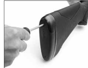
Вставьте отвертку в отверстия амортизирующего затыльника.
