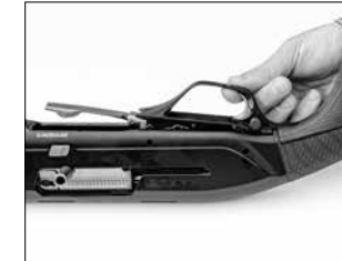
Снимите группу спускового механизма со ствольной коробки.
