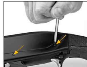
Presione las clavijas de la unidad del gatillo a través del cajón de mecanismos.
