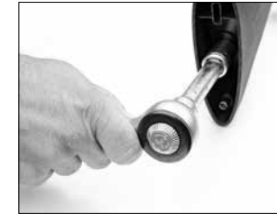
Используйте торцевой гаечный ключ, чтобы извлечь из приклада винт
