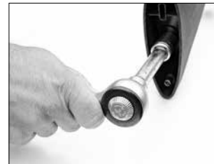
Usare una chiave a tubo per estrarre la vite di fissaggio del calcio.
