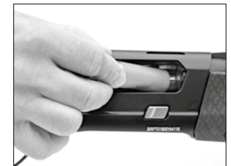
Inserte un proyectil en la culata a través del puerto de expulsión.
