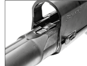
Allineare l'asta del manicotto con l'alloggiamento nella carcassa.
