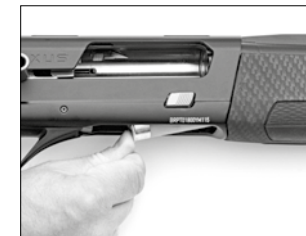
Inserte el proyectil en la parte inferior del cajón de mecanismos y empujelo hacia adelante hasta que ingrese al cargador.
