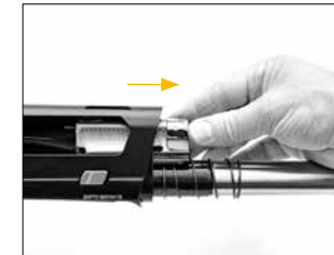
Выдвиньте затвор вперед и отделите его от ствольной коробки.
