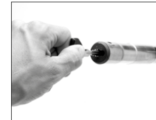
Чтобы снять ограничитель на три выстрела, используйте ключ или маленькую отвертку, нажмите и поверните его на четверть оборота
