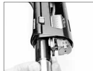
Guidare la biella della culatta nella cavità della molla di recupero.
