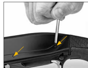
Premere le spine del sottoguardia attraverso la carcassa.
