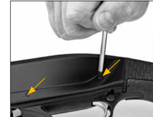
Протолкните штифты группы спускового механизма через ствольную коробку
