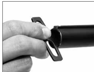
Usare la chiave inglese per strozzatori per sostituire gli strozzatori stessi.
