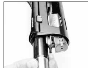
Coloque la guía de deslizamiento del cerrojo en el zócalo dentro de la guía de resorte recuperador.
