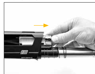
Far scorrere il gruppo dell'otturatore in avanti fino a farlo uscire dalla carcassa.
