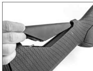
Inserire la parte anteriore del poggiaanca nell'alloggio del calcio, abbassare il retro per installarlo. Stringere la vite posteriore senza troppo stringere.
