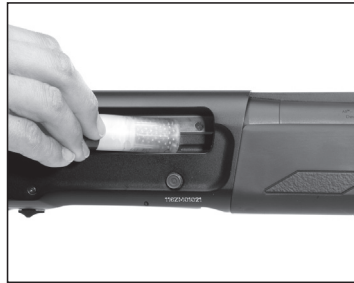
Eine Patrone durch die Auswurföffnung in das Patronenlager einführen
