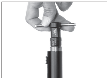
Använd det medlevererade specialverktyget för att ta ur och sätta i choketuber.
