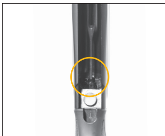
Введите соединитель ползуна в его ложу в подавателе
