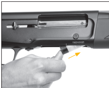
Stoppa i en patron i uttaget under lådan och tryck den så långt fram det går.
