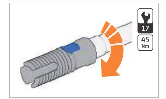
Fig. 87: Insert flash hider
