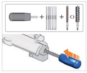
*Fig. 107: Insert handle rod*
