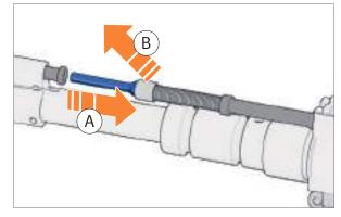
Fig. 98: Remove rod
