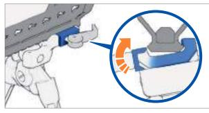
Fig. 37: Insert bipod
