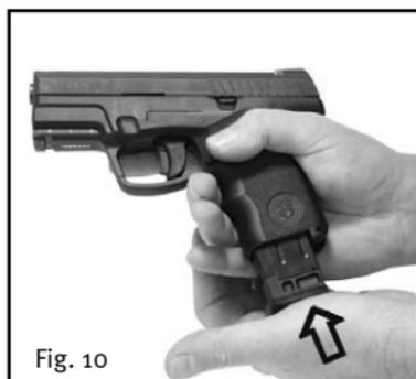
Insérer le chargeur dans la conduite de chargeur jusqu'à ce que le système de déverrouillage du chargeur s'engrène.
