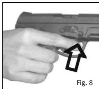
Cette sécurité peut être activée et désactivée manuellement, si nécessaire, en plus de la sécurité de réarmement (1).
