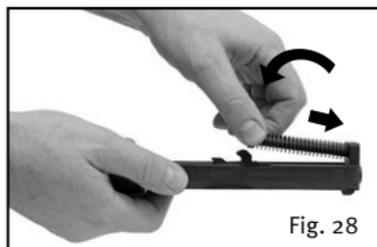
2. Insérer le ressort récupérateur dans la culasse en l'enfonçant vers l'intérieur.
