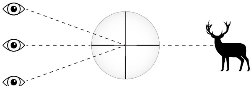
Para adaptar el ajuste de la retícula a las condiciones particulares de caza o al tipo de munición, utilice el ajuste de altura (6) y el ajuste lateral (7). No se percibe ningún movimiento de la retícula durante el ajuste de la misma. Por lo tanto, la retícula siempre se encuentra en el centro de la imagen. El ajuste de la retícula del visor se realiza de la siguiente manera:
