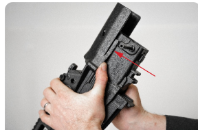
Figure 42 - Poussez le repose-joue vers le haut
