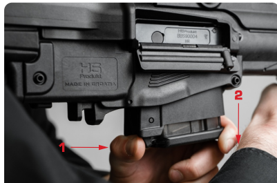
Figure 64 - Retrait du chargeur
