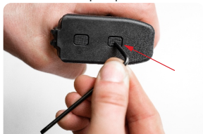
Figure 50 - Démontage du chargeur
