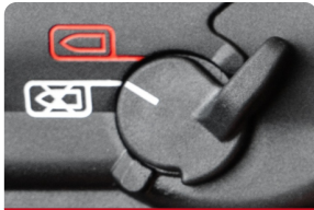
Figure 4 - Sélecteur de tir - SAFE
