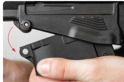
Figure 22 - Retrait du puits du chargeur
