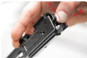
Figure 24 - Retrait du percuteur
