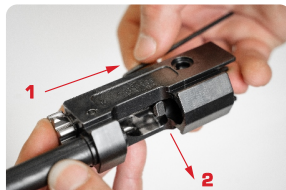
Figure 25 - Retrait de la goupille de la carcasse
