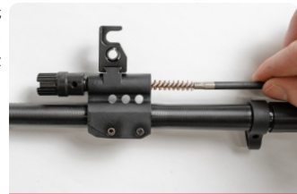
Figure 75 - Nettoyage du bloc de gaz
