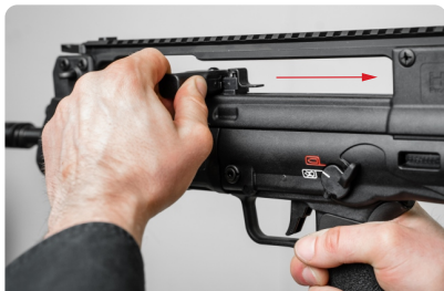
Figure 11 - Extraction du groupe porte-culasse
