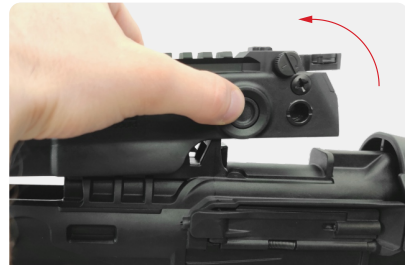
Figure 18 - Retrait de la carcasse supérieure
