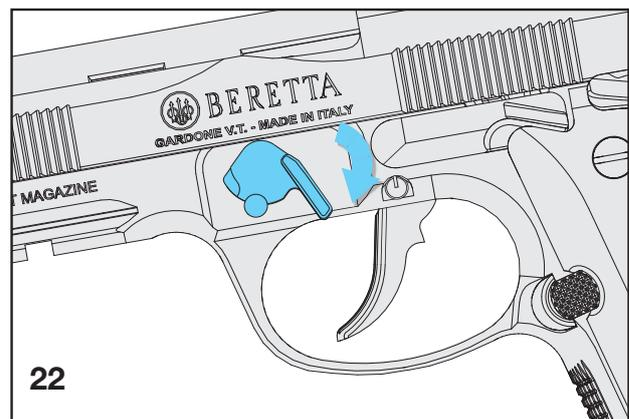
Tirez l'ensemble glissière-canon avec le bloc de verrouillage, le ressort récupérateur et le guide de ressort vers l'avant.
